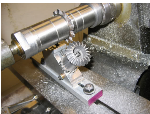
Σχήμα 11.2 : Κοπή κωνικού γραναζιού
