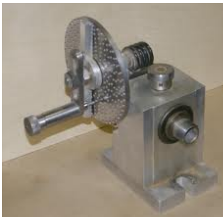
Σχήμα 8.3 : Διαιρούμενη κεφαλή τύπου Myford
