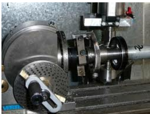
Σχήμα 9.2 : Διαγραμματική διάταξη κεφαλής τύπου Myford τοποθετημένη στον κάθετο ολισθητήρα
