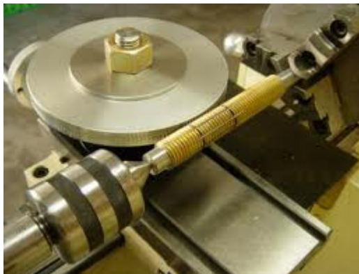
Σχήμα 10.9 : Φρεζάρισμα με κύλιση ατέρμονα κοχλία
