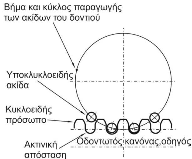
Σχήμα 5.4 : Διάρθρωση οδοντωτού κανόνα με ακιδωτό τροχό
