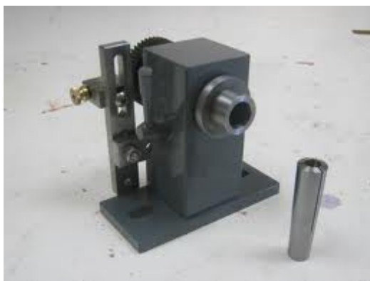
Σχήμα 8.2 : Άμεση διαίρεση κεφαλής
