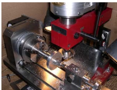
Σχήμα 9.5 : Διαιρούμενη κεφαλή με ένα στήριγμα κόπτη υποστηριγμένο από μια ακίδα
